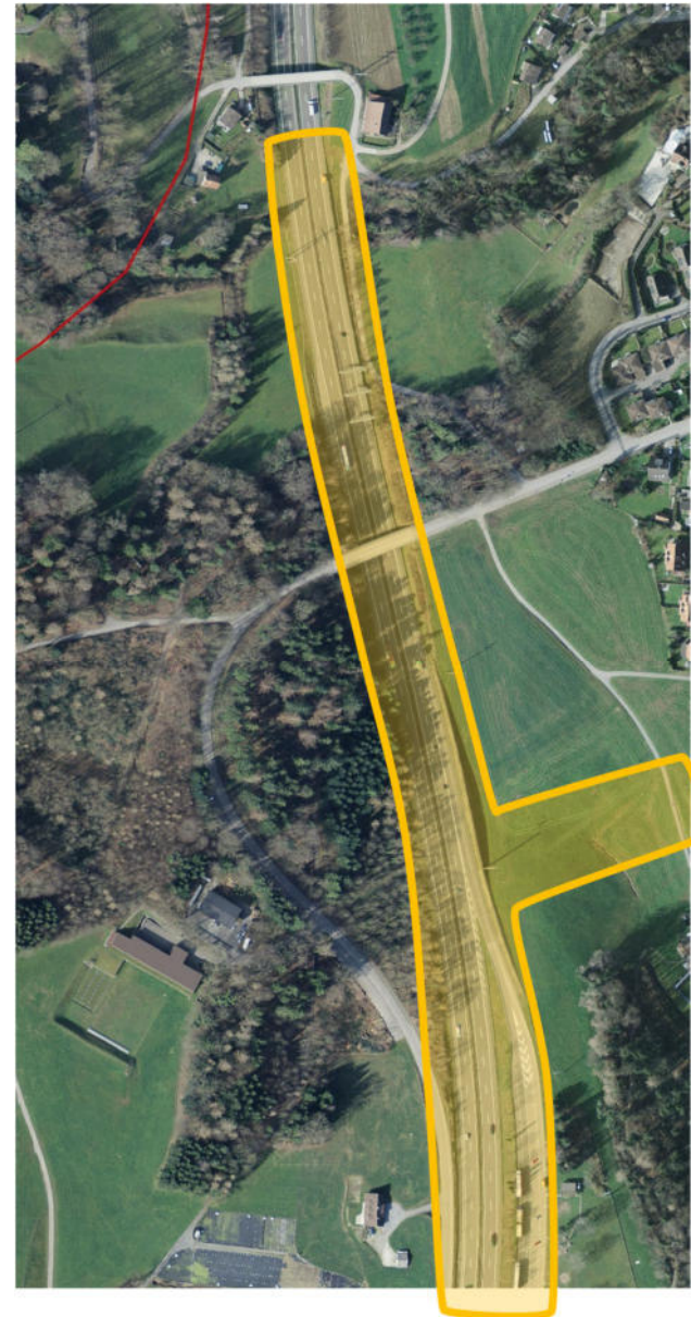
Abb. 41: Ausgestaltung und Platzbedarf des neuen Autobahnanschlusses
