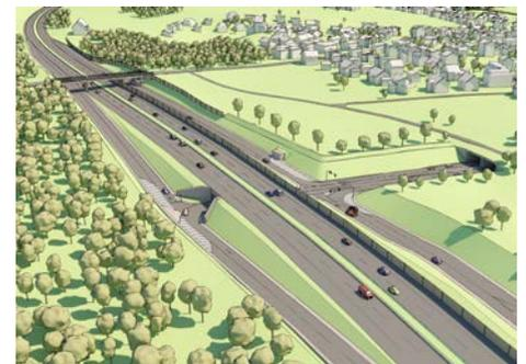
Die unmittelbar an der Autobahn angeordneten Rampen ermöglichen einen massvollen Landbedarf.
